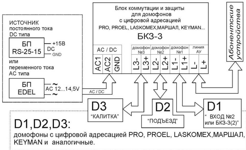
Возможно увеличение количества подключаемых домофонов путём последовательного подключения коммутаторов. Вариант для подключения до 5-ти домофонов на рис.2 При использовании в схеме более 1-го коммутатора приоритетом в работе пользуются домофоны подключаемые к 1-му коммутатору.
